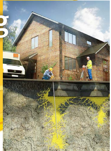
Bild 1: Produkte auf Polymerbasis, die zum Beispiel im Boden zur Erhöhung der Tragfähigkeit eingesetzt werden, sollen nach Vorstellung des DIBt bereits im Vorfeld bei Migrationsstudien ihre Unbedenklichkeit nachgewiesen haben. URETEK hat dies als Hersteller von Injektionsystemen durch unabhängige Stellen getan. (Bild: URETEK Deutschland)
