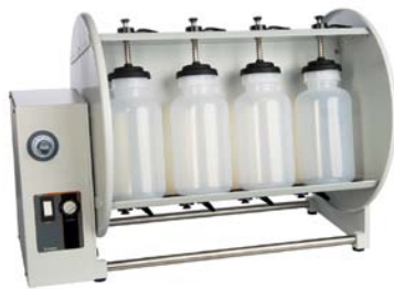
Bild 2: Im Labor wird unter praxisnahen Bedingungen getestet, ob und wieviel eines Schadstoffes aus dem Produkt entweicht, zum Beispiel mit einem Überkopfschüttler. Dabei kommen die Prüfkörper mit der zehnfachen Menge Wasser 24 h lang bei 23 °C in das Gerät. (Bild: Heidolph Instruments)
