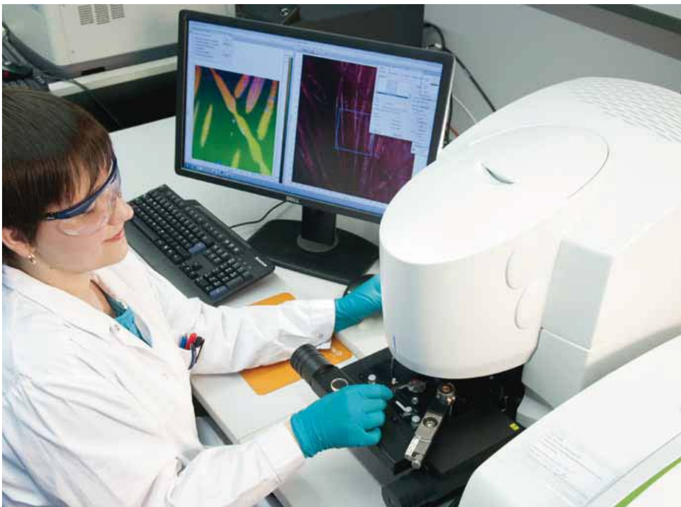
1 Das neue Infrarot (IR)-Mikroskop kann dank seines 16-fach-Sensors deutlich schneller messen.
