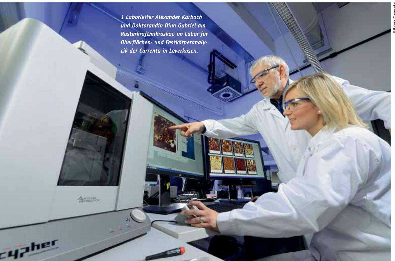
renzmessungen erfasst wurde, lassen sich diese mit der Messspitze erfühlen und zweidimensional lokalisieren. Indem sich die Mitarbeiterin im Currenta-Oberflächen- und Festkörperanalytiklabor viele verschiedene Bereiche der Probenoberfläche anschaut, entsteht binnen weniger Stunden ein dreidimensionales Verständnis der Vermischungsqualität des Produkts.
