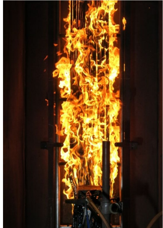
Abbildung 3: Prüfung der senkrechten Flammenausbreitung Figure 3: Testing the vertical flame spread
