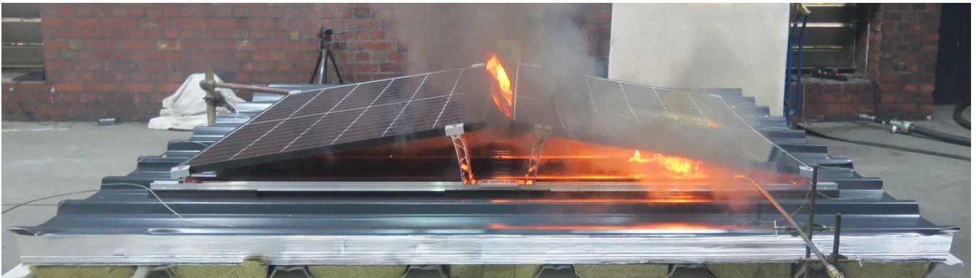
Abb. 3: Exemplarischer Versuchsaufbau mit zwei PV-Modulen in Ost Westausrichtung auf einem Flachdach
