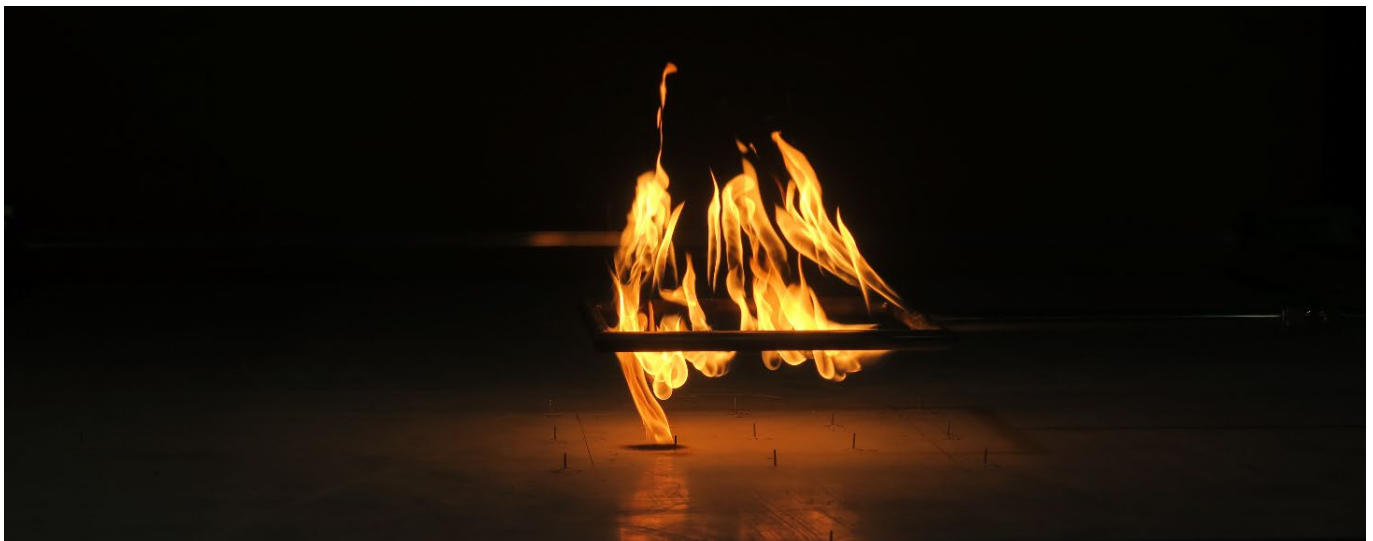
Abb. 2: Gasbrenner entsprechend der CLC/TR 50670 Fig. 2: Gas burner in accordance with CLC/TR 50670
