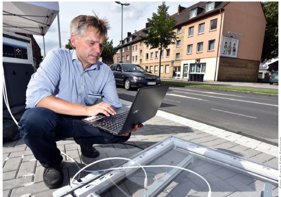
Mit einer mobilen Messapparatur werden die Stickoxid-Werte auf der Bottroper Photoment-Testfläche ermittelt.
